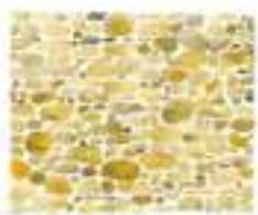
Appareillage de moellons équarris, à une assésée, de taille brute et non assésés.
